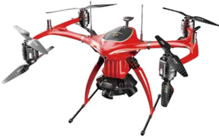
哈瓦 4 轴 8 旋翼无人机 (双电版)
