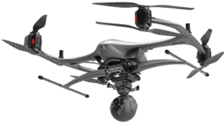
哈瓦 4 轴 8 旋翼无人机
